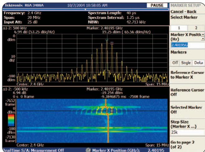
► Спектрограмма с высоким разрешением показывает изменение состояния нестационарного сигнала, что позволяет быстро решить проблему. На рисунке боковые полосы частот шириной 500 кГц показаны как часть нестационарного состояния сигнала, который изменяется скачкообразно по мере переключения частот.
