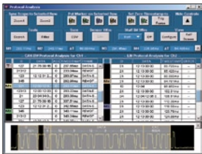
Измерение временных характеристик и декодирование протокола CAN и LIN
