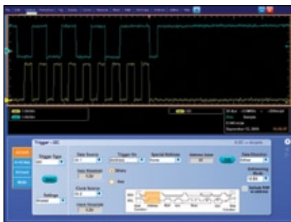
Простой запуск по указанному адресу шины
