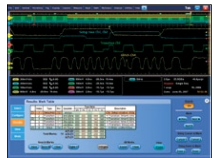
Быстрый анализ нескольких событий в захваченном сигнале
