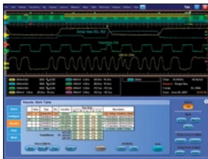
Быстрый анализ событий в захваченном сигнале
