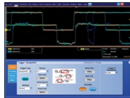
Выделение нарушений времени установки и удержания длительностью от 360 пс
