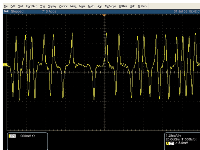
Рисунок 4. Сигнал канала чтения жесткого диска (5 Гбит/с, 2 точки на ячейку); AWG7121B с частотой дискретизации 10 Гвыб./с
