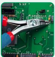
Миниатюрная головка с глубоким рельефом для обеспечения лучшего доступа. Короткие прочные губки. Абсолютно плоский срез. Позволяют резать медные провода диаметром 0,10-0,65 мм. Длина ручек 115 мм (модель 5049) и 140 мм (модель 7049).
