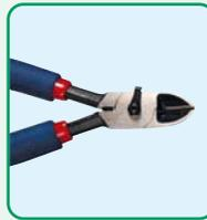
Большая овальная головка. Позволяют резать стальную проволоку диаметром от 0,1 мм до 1,6 мм. Длина ручек 140 мм.
