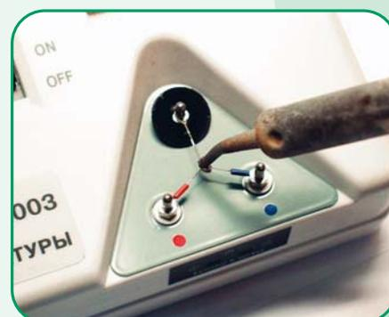
жидкости или припоя в диапазоне от 0 до 600 °С с погрешностью  $\pm 5$  °С. Прибор снабжен 3,5-разрядным ЖКИ, индикатором разряда батареи, индикатором выгорания чувствительного элемента термопары; Прибор имеет портативное исполнение и питается от 9 В батареи «Крона». Срок службы 4 года при правильном использовании.
