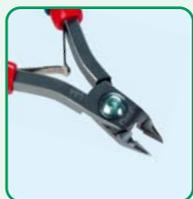
Миниатюрная конусная головка с глубоким рельефом для обеспечения лучшего доступа. Кусачки предназначены для работы с твердыми материалами, в том числе с вольфрамовыми сплавами. Позволяют резать стальные провода диаметром 0,10-0,25 мм. Плоский срез. Длина ручек 115 мм.
