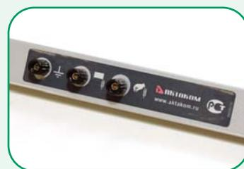
Предназначен для подключения к цепи заземления антистатических коврика и браслета, паяльной станции и прочего оборудования. Для соединения с шиной заземления лаборатории комплектуется 3-х метровым проводом с кольцевыми наконечниками, обеспечивающими хороший электрический контакт. Является неотъемлемой частью APM-5057, а также может опционально применяться для столов APM-5054/5055/5056.
