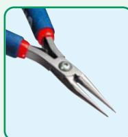
Губки круглогубцев выполнены в виде длинных тонких конусов с очень тонкими кончиками (каждый размером 0,76 × 0,76 мм). Длинные губки (3,3 см) позволяют формировать петли диаметром от 6,4 мм до 0,76 мм. Тонкий профиль облегчает доступ к мелким деталям. Внутренние поверхности губок сделаны гладкими. Длина ручек 115 мм (модель 531) и 140 мм (модель 731).
