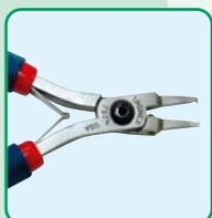
Длинные и очень узкие губки с миниатюрными режущими кромками на торце позволяют осуществлять резку в ограниченном пространстве. Абсолютно плоский срез. Позволяют резать медные провода диаметром 0,10-0,80 мм. Длина ручек 115 мм (модель 5074) и 140 мм (модель 7074).
