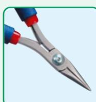
Плоскогубцы с короткими губками и тонкими кончиками особенно удобны при работе с проволокой. Короткие губки обеспечивают повышенную прочность захвата кончиками плоскогубцев. Во избежание появления зазубрин на изделии все четыре внутренние кромки губок скруглены, а внутренние поверхности губок сделаны гладкими. Длина ручек 115 мм (модель 513) и 140 мм (модель 713).
