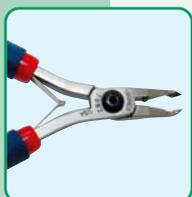
Наиболее популярные модели угловых кусачек. Маленькая головка с углом 50° и рельефом для обеспечения лучшей видимости. Плоский срез. Позволяют резать медные провода диаметром 0,10-0,65 мм. Длина ручек 115 мм (модель 5082) и 140 мм (модель 7082).
