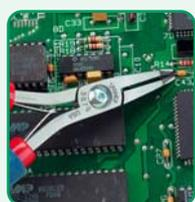
Наиболее популярные модели концевых кусачек. Губки в два раза шире, чем у стандартных концевых кусачек и имеют глубокий рельеф для обеспечения лучшего доступа. Абсолютно плоский срез. Позволяют резать медные провода диаметром 0,10-0,65 мм. Длина ручек 115 мм (модель 5070) и 140 мм (модель 7070).
