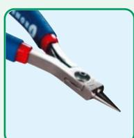
Губки круглогубцев выполнены в виде коротких конусов с очень тонкими кончиками (каждый размером 0,76 × 0,76 мм). Короткие губки обеспечивают повышенную жесткость на кончиках круглогубцев при работе с проводами большого диаметра. Длина ручек 115 мм (модель 532) и 140 мм (модель 732).
