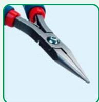
Плоскогубцы с тонкими кончиками особенно удобны при монтаже электронных компонентов. Очень тонкие кончики губок - 1,5 × 1,3 мм. Во избежание появления зазубрин на изделии все четыре внутренние кромки губок скруглены. Внутренние поверхности губок могут быть гладкими (модели 511 и 711) или рифлеными (модели 512 и 712). Длина ручек 115 мм (модели 511 и 512) и 140 мм (модели 711 и 712).
