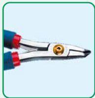
Самые популярные угловые кусачки. Маленькая режущая головка с углом 50° и рельефом для обеспечения лучшей видимости. Предназначены для работы с твердыми материалами, в том числе, с вольфрамовыми сплавами. Прочность сочетается с точностью реза. Плоский срез. Позволяют резать стальную проволоку диаметром 0,10-0,18 мм. Длина ручек 115 мм.
