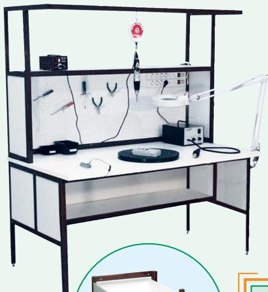
Столы этой серии имеют традиционный дизайн. Они просты, универсальны, удобны. Нижняя полка глубиной 30 см, расположенная под столешницей, предназначена для размещения приборов, инструмента, технической документации.
