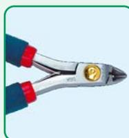
Миниатюрные кусачки для тонкой работы, например с компонентами для поверхностного монтажа. Предназначены для работы с твердыми материалами, в том числе, с вольфрамовыми сплавами. Модель 5311W обеспечивает полуплоский срез и позволяет резать стальные провода диаметром 0,20-0,33 мм. Модель 5312W обеспечивает плоский срез и позволяет резать стальные провода диаметром 0,15-0,25 мм. Длина ручек 115 мм.
