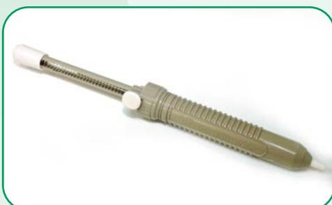
*Предназначен для ручных операций при демонтаже компонентов. За счет движения поршня создается высокое разрежение с помощью которого происходит удаление припоя с микросхемы. Корпус оловоотсоса и его съемный наконечник выполнены из термостойкого пластика*
