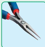
Губки круглогубцев выполнены в виде длинных тонких конусов с очень тонкими кончиками (каждый размером  $0,76 \times 0,76$  мм). Длинные губки (3,3 см) позволяют формировать петли диаметром от 6,4 мм до 0,76 мм. Тонкий профиль облегчает доступ к мелким деталям. Внутренние поверхности губок сделаны гладкими. Длина ручек 115 мм (модель 531) и 140 мм (модель 731).
