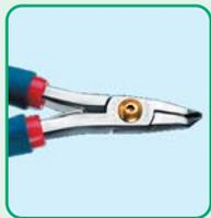
Самые популярные угловые кусачки. Маленькая режущая головка с углом  $50^\circ$  и рельефом для обеспечения лучшей видимости. Предназначены для работы с твердыми материалами, в том числе, с вольфрамовыми сплавами. Прочность сочетается с точностью реза. Плоский срез. Позволяют резать стальную проволоку диаметром 0,10-0,18 мм. Длина ручек 115 мм.
