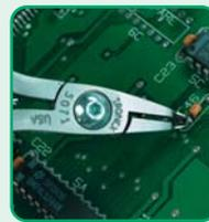
Для работы с компонентами для поверхностного монтажа. Чрезвычайно маленькая головка и острые режущие кромки. Тонкий кончик. Часто используются для работы под микроскопом. Абсолютно плоский срез. Позволяют резать медные провода диаметром 0,10-0,80 мм. Длина ручек 115 мм (модель 5071) и 140 мм (модель 7071).
