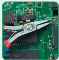
Наиболее популярные модели концевых кусачек. Губки в два раза шире, чем у стандартных концевых кусачек и имеют глубокий рельеф для обеспечения лучшего доступа. Абсолютно плоский срез. Позволяют резать медные провода диаметром 0,10-0,65 мм. Длина ручек 115 мм (модель 5070) и 140 мм (модель 7070).
