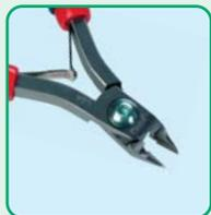
Миниатюрная конусная головка с глубоким рельефом для обеспечения лучшего доступа. Кусачки предназначены для работы с твердыми материалами, в том числе, с вольфрамовыми сплавами. Позволяют резать стальные провода диаметром 0,10-0,25 мм. Плоский срез. Длина ручек 115 мм.
