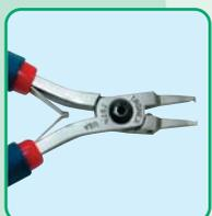
Длинные и очень узкие губки с миниатюрными режущими кромками на торце позволяют осуществлять резку в ограниченном пространстве. Абсолютно плоский срез. Позволяют резать медные провода диаметром 0,10-0,80 мм. Длина ручек 115 мм (модель 5074) и 140 мм (модель 7074).
