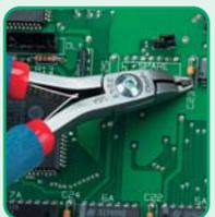
Миниатюрная головка с глубоким рельефом для обеспечения лучшего доступа. Короткие прочные губки. Абсолютно плоский срез. Позволяют резать медные провода диаметром 0,10-0,65 мм. Длина ручек 115 мм (модель 5049) и 140 мм (модель 7049).
