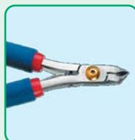
Конусная головка с углом 50° и удлиненными режущими кромками. Предназначены для работы с твердыми материалами, в том числе, с вольфрамовыми сплавами. Позволяют резать стальную проволоку диаметром 0,10-0,18 мм. Длина ручек 115 мм (модель 5081W) и 140 мм (модель 7081W).
