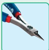
Губки круглогубцев выполнены в виде коротких конусов с очень тонкими кончиками (каждый размером  $0,76 \times 0,76$  мм). Короткие губки обеспечивают повышенную жесткость на кончиках круглогубцев при работе с проводами большого диаметра. Длина ручек 115 мм (модель 532) и 140 мм (модель 732).
