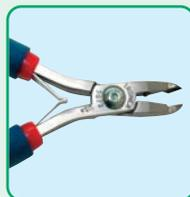
Большая головка с углом 50° и рельефом для обеспечения лучшей видимости. Особенно удобны для одновременной резки нескольких проводов. Позволяют резать медные провода диаметром 0,20-0,65 мм. Длина ручек 115 мм (модель 5072) и 140 мм (модель 7072).
