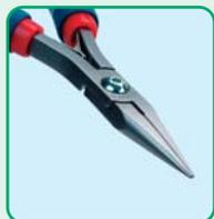
Плоскогубцы с тонкими кончиками особенно удобны при монтаже электронных компонентов. Очень тонкие кончики губок -  $1,5 \times 1,3$  мм. Во избежание появления зазубрин на изделии все четыре внутренние кромки губок скруглены. Внутренние поверхности губок могут быть гладкими (модели 511 и 711) или рифлеными (модели 512 и 712). Длина ручек 115 мм (модели 511 и 512) и 140 мм (модели 711 и 712).
