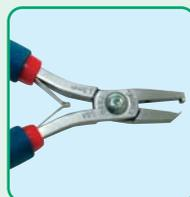
Позволяют отрезать проводники фиксированной длины для уменьшения нагрузки на компоненты. Величина зазора может быть установлена в пределах от 0,5 мм до 3,0 мм. Специальный стопорный винт предотвращает затупление режущей кромки. Позволяют резать медные провода диаметром 0,20-0,65 мм. Длина ручек 115 мм (модель 5030) и 140 мм (модель 7030).
