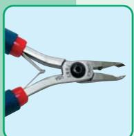
Наиболее популярные модели угловых кусачек. Маленькая головка с углом 50° и рельефом для обеспечения лучшей видимости. Плоский срез. Позволяют резать медные провода диаметром 0,10-0,65 мм. Длина ручек 115 мм (модель 5082) и 140 мм (модель 7082).
