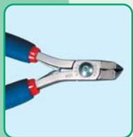
Большая остроконечная головка с углом 50°. Короткие губки для лучшего контроля резки. Позволяют резать медные провода диаметром 0,20-0,65 мм. Длина ручек 115 мм (модель 5004) и 140 мм (модель 7004).
