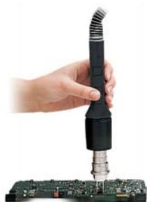
Паяльная система ST325 в базовой комплектации предназначена для выполнения ручных операций, поэтому конструкторы PACE уделили особое внимание эргономике инструмента. Одна из наиболее важных его деталей - регулируемый вакуумный захват, расположенный по оси сопла.
