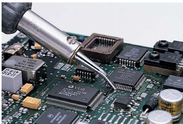
Монтаж SMD - корпусов с помощью наконечника "миниволна"
