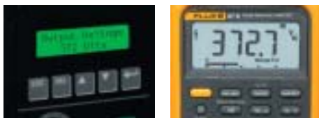
Отсчет напряжения при использовании фильтра нижних частот.
