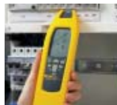
Определение местонахождения предохранителей/прерывателей и привязка к цепям
