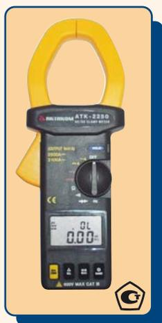
Надежные, мощные токовые клещи с расширенным диапазоном токов (до 2,5 кА) для работы в силовых электроэнергетических установках. Максимальный размер охвата для шины – 65×24 мм, диаметр охвата – 55 мм. Имеют аналоговый выход и могут использоваться как автономный прибор или в составе измерительного комплекса. Частотный диапазон измеряемых токов и напряжений расширен до 1 кГц
