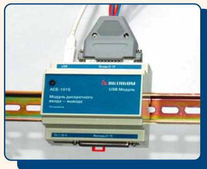
*Модуль дискретного ввода-вывода позволяет организовать 16-ти канальный обмен данными между ПК и любым устройством, имеющим цифровой вход/выход TTL-уровня. Используя модуль ACE-1016 можно отслеживать логическое состояние 16-ти датчиков и управлять исполнительными устройствами. Выходы модуля реализованы на быстродействующих МОП-реле с временем срабатывания/отпускания менее 1 мс*
