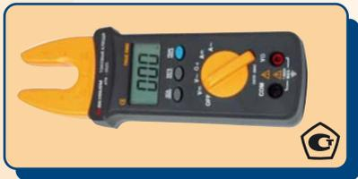
*Этот прибор, может измерить протекающий по проводу ток, не размыкая его. Можно измерить как переменный, так и постоянный ток. В отличие от обычных токовых клещей, датчик тока у этого прибора неподвижный, поэтому не требуется при каждом измерении размыкать и замыкать захват токовых клещей. При измерении переменного напряжения и тока отображается истинное среднеквадратическое значение (TRUE RMS)*
