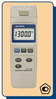
Четырехканальный цифровой измеритель температуры позволяет измерять температуру термомпарами К (хромель-алюмель) и J (железо-константан) типа по шкалам Цельсия и Фаренгейта. Прибор имеет функции удержания показаний, фиксацию минимального и максимального измеренного значения. При использовании совместно с прибором дополнительного кабеля и программного обеспечения можно осуществлять передачу данных в компьютер через порт RS-232
