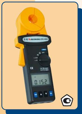
*Прибор предназначен для измерения сопротивления заземления, тока утечки, а также прозвонки цепи. Позволяет производить измерения только на одном проводе заземления без использования дополнительных электродов и может применяться для тестирования систем с множественным заземлением без их отключения*
