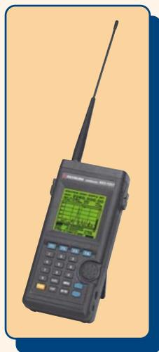
*Этот малогабаритный прибор является идеальным инструментом для испытания, установки и обслуживания стационарного и подвижного телекоммуникационного оборудования: мобильных сотовых телефонов, пейджинговых систем, радиостанций персональной и служебной радиосвязи, оборудования спутниковой связи и кабельного телевидения, а также измерительных антенн*
