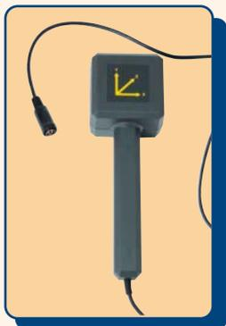
Данный прибор предназначен для измерения электромагнитной индукции по трем координатным осям (X, Y, Z). Используется для определения электромагнитной индукции возле шин питания, около мониторов компьютеров, видео аппаратуры, теле аппаратуру и других подобных устройств. Имеет широкий диапазон измерений электромагнитной индукции от 3 до 2000 мкТл, а также измерение переменного электромагнитного поля в диапазоне частот от 30 до 300 Гц
