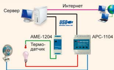
Рис. 4. Пример удаленного доступа к приборам USB-лаборатории АКТАКОМ через Интернет-сервер
