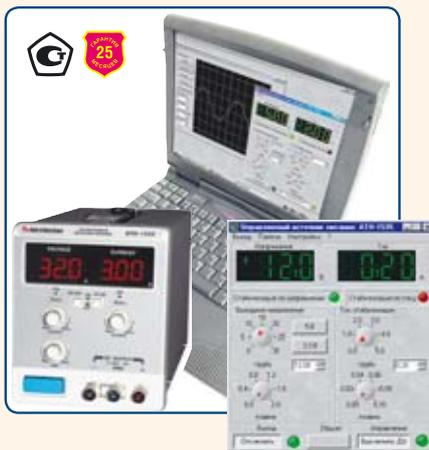
*Аналоговые дистанционно-управляемые источники постоянного напряжения с цифровой индикацией предназначены для проведения измерений с динамично меняющимися режимами питающего напряжения в составе управляемого с ПК измерительного комплекса. Приборы выдают регулируемое (вручную или от ПК через USB-порт) постоянное стабилизированное напряжение и стабилизированный ток*
