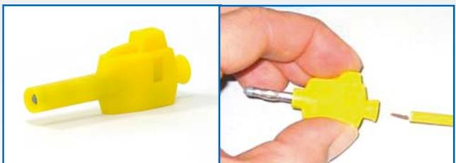
Вилка-адаптер представляет собой устройство, с одной стороны которого разъем типа "изолированный банан" с изолированным наконечником для большей безопасности, а с другой вход с зажимом для соединения с любым неизолированным проводом. Позволяет надежно подключать к любым измерительным приборам, имеющим вход диаметром 4 мм, провод любой длины, и сделать это можно без паяльного соединения
