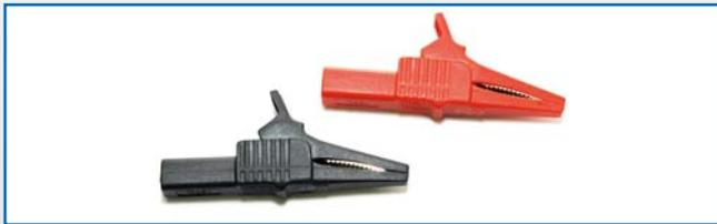
Насадка-крокодил. Имеет разъем для подключения соединительных кабелей диаметром наконечника 4 мм. Используется для фиксирования соединительных проводов. Изоляция CAT 3 (1000 V). Неразборная. Длина 83 мм, высота 36 мм.
