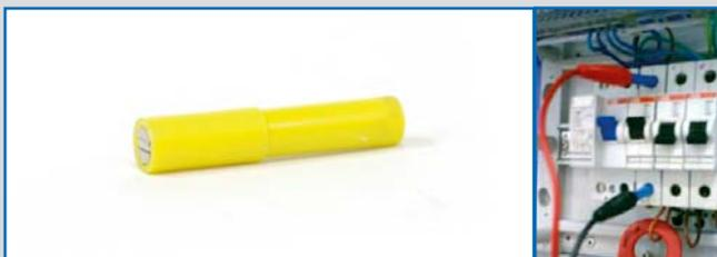
Гарантирует надежное подключение измерительных проводов с вилкой стандартного диаметра, обеспечивая постоянный и надежный контакт соединительных проводов находящихся под напряжением. Максимальное напряжение 33 В AC и 70 В DC, Максимальный ток до 12 А. Длина магнитного адаптера 35 мм. Диаметр магнитного наконечника 7 мм.
