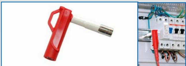
Обеспечивает постоянный контакт измерительных проводов с вилкой диаметра 4 мм, гарантируя надежное соединение измерительных проводов находящихся под напряжением. Максимальное напряжение 33 В AC и 70 В DC, Максимальный ток до 12 А. Длина магнитного адаптера 60 мм. Высота 50 мм. Диаметр магнитного наконечника 9 мм.
