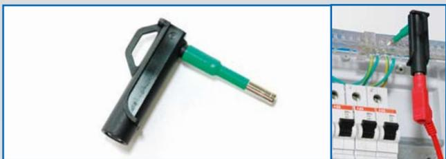
Создает постоянный контакт измерительных проводов с вилкой диаметра 4 мм, обеспечивая надежное соединение измерительных проводов находящихся под напряжением. Максимальное напряжение 33 В AC и 70 В DC, Максимальный ток до 12 А. Длина магнитного адаптера 60 мм. Высота 50 мм. Диаметр магнитного наконечника 4 мм.
